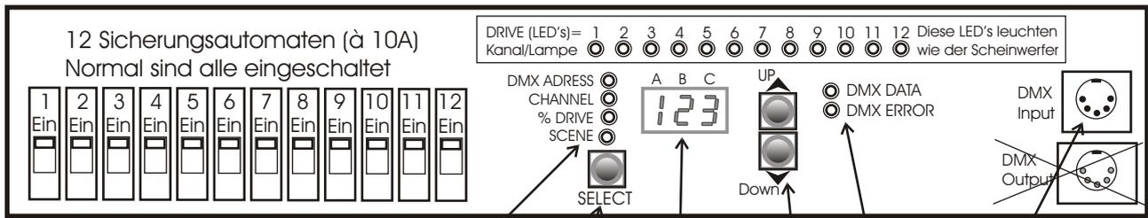
4 LED's für die Statusanzeige    Menu Auswahl    Display (LED-Anzeige)    Einstell-taster    DMX Daten-anzeige    Kabelanschluss Steuerpult
